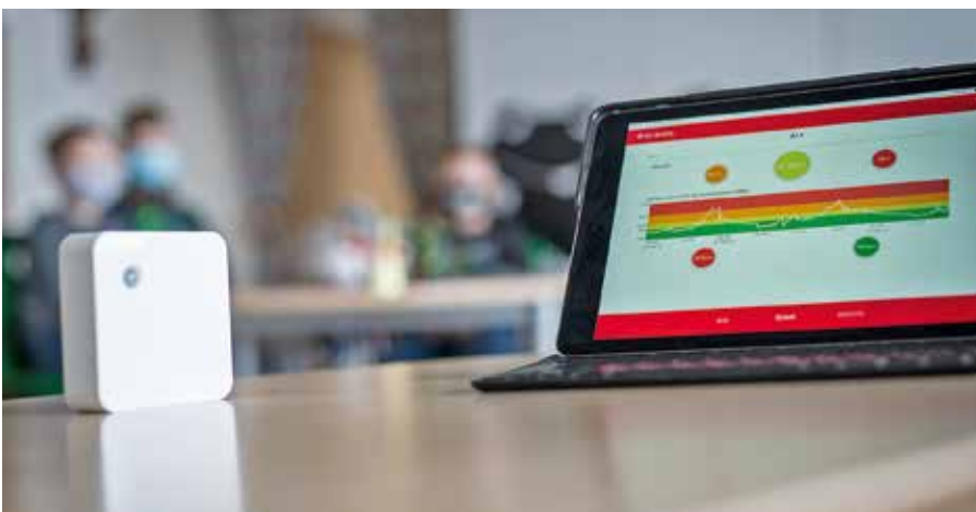
Das Dashboard von MVV zeigt im Ampelsystem den CO 2 -Gehalt in Gebäuden an.
