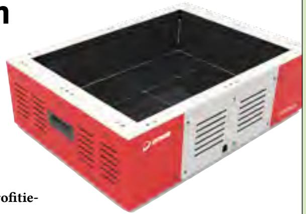
**Ophir FluxGage bietet die Lösung.** Das kompakte und vielseitige Messgerät liefert ohne aufwendige Kalibrierung die relevanten Lichtparameter einer LED-Straßenleuchte: Gesamtlichtstrom, Korrelierte Farbtemperatur (CCT), Farbwiedergabewerte (CRI, TM-30), allgemeine und Farbgleichmäßigkeit des Lichts und Flimmern werden in nur wenigen Sekunden gemessen.
